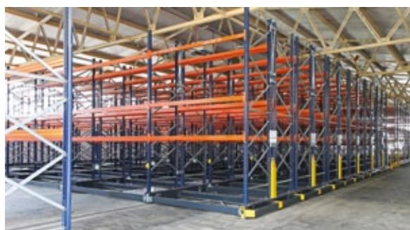
Bei dem Palettenverschieberegalfest lassen sich die Regale zusammenzuschlieben, was die Lagerkapazität weiter erhöht. Der direkte Zugriff auf jede einzelne Palette wird dennoch gewährleistet.
