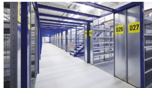
Lagerbühnen bieten einen effizienten Raumgewinn, speziell in der Höhe. Je nach Raumhöhe ist eine Verdoppelung oder Verdreifachung der zur Verfügung stehenden Lagerfläche möglich.
