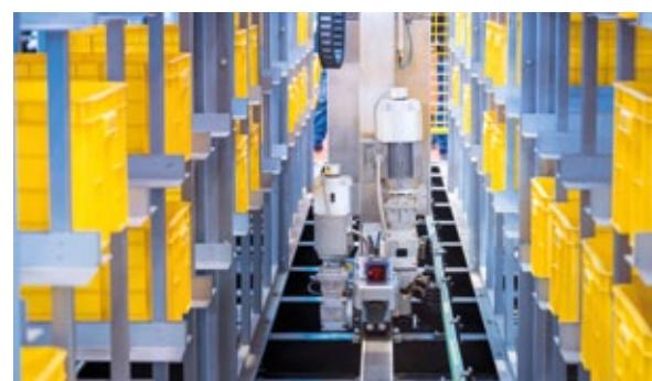
Automatische Kleinteilelager gewährleisten eine äußerst platzsparende Lagerung von Kleinteilen in Behältern, Tablaren oder Kartons. Diese werden in Regalen auf Winkelauflagen – unter voller Nutzung der Raumhöhe – gelagert.
